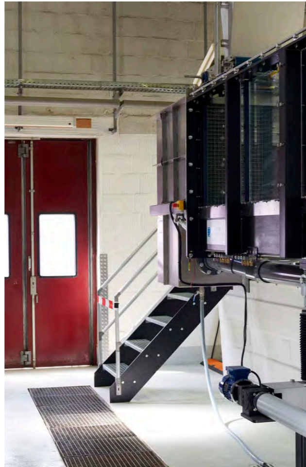
Schafft reale Bedingungen für Simulationen: Die Strömungsrinne im Wasserbaulabor
