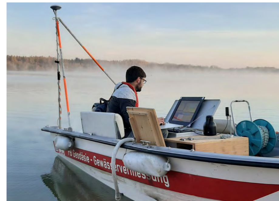
Das Messboot ermöglicht dem Fachbereich Geodäsie Gewässervermessungen
